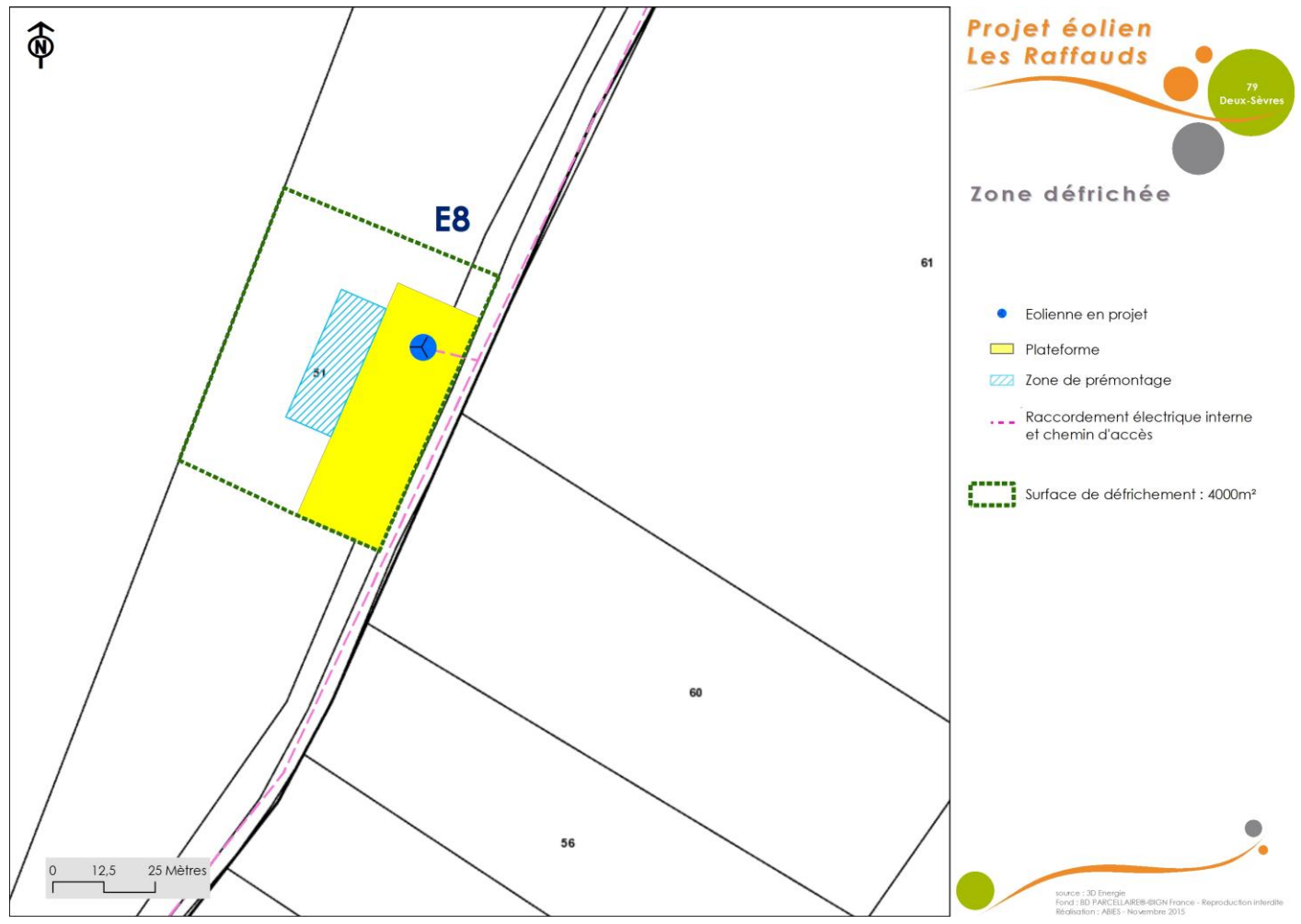
Carte 89 : Surface défrichée au niveau de l'éolienne E8
